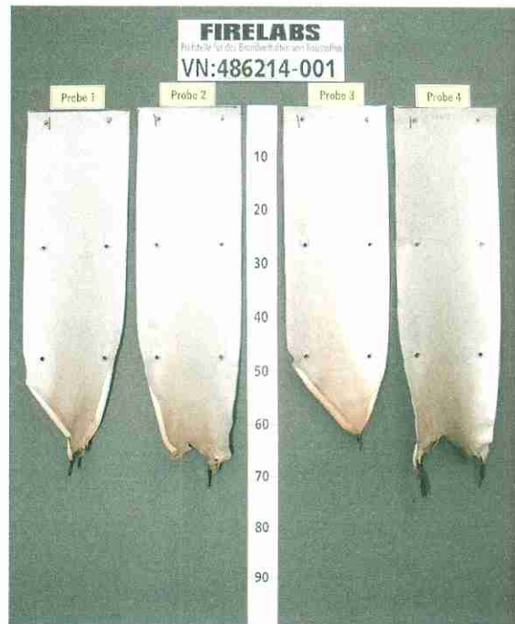
Bild 2 Aussehen des Probekörpers nach dem Brandversuch
